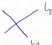
Schnittpunkt der Linien ist  $\vec{p} = \vec{l}_1 \times \vec{l}_2$
